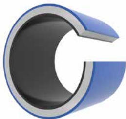
МУЛЬТИПЛЕКС III ПРО Труба 3-х слойная с соэкструзионными слоями. Наружный синий или чёрный ПЭ100 или ПЭ100RC, средний неокрашенный ПЭ100, внутренний синий или чёрный ПЭ100 с защитным покрытием ПРО.
