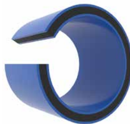
МУЛЬТИПЛЕКС III ПРО Труба 3-х слойная с соэкструзионными слоями. Наружный синий ПЭ100RC, средний чёрный ПЭ100, внутренний синий ПЭ100RC и защитным покрытием ПРО.
