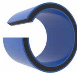
МУЛЬТИПЛЕКС III Труба 3-х слойная с соэкструзионными слоями. Наружный синий ПЭ100RC, средний чёрный ПЭ100, внутренний синий ПЭ100RC.
