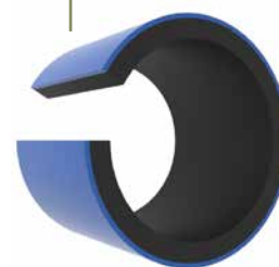
МУЛЬТИПЛЕКС II Труба 2-х слойная с соэкструзионными слоями. Наружный синий ПЭ100RC, внутренний чёрный ПЭ100 или наружный чёрный ПЭ100, внутренний синий ПЭ100RC.
